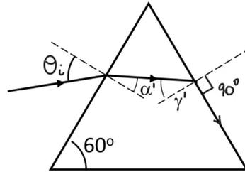
El rayo de luz no emergerá del prisma cuando el ángulo de refracción  $\beta$  sea igual a  $90^\circ$ . Aplicamos la Ley de Snell para este caso:
